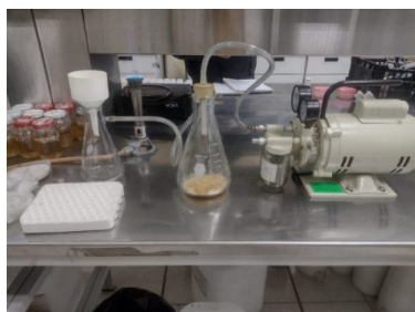
Figura 3. Separación de biomasa a través de filtración y usando una bomba de vacío.
