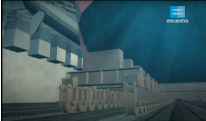
Foto 37. Apoyo de navío sobre buggies/camas.
