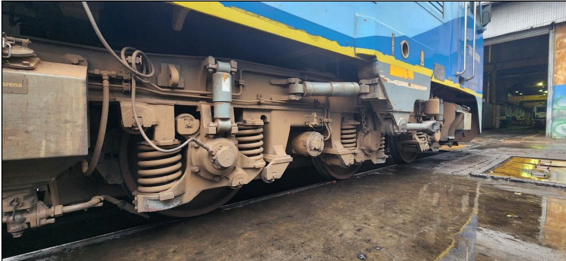
Figura 19- Suciedad de bogie locomotora CKD
