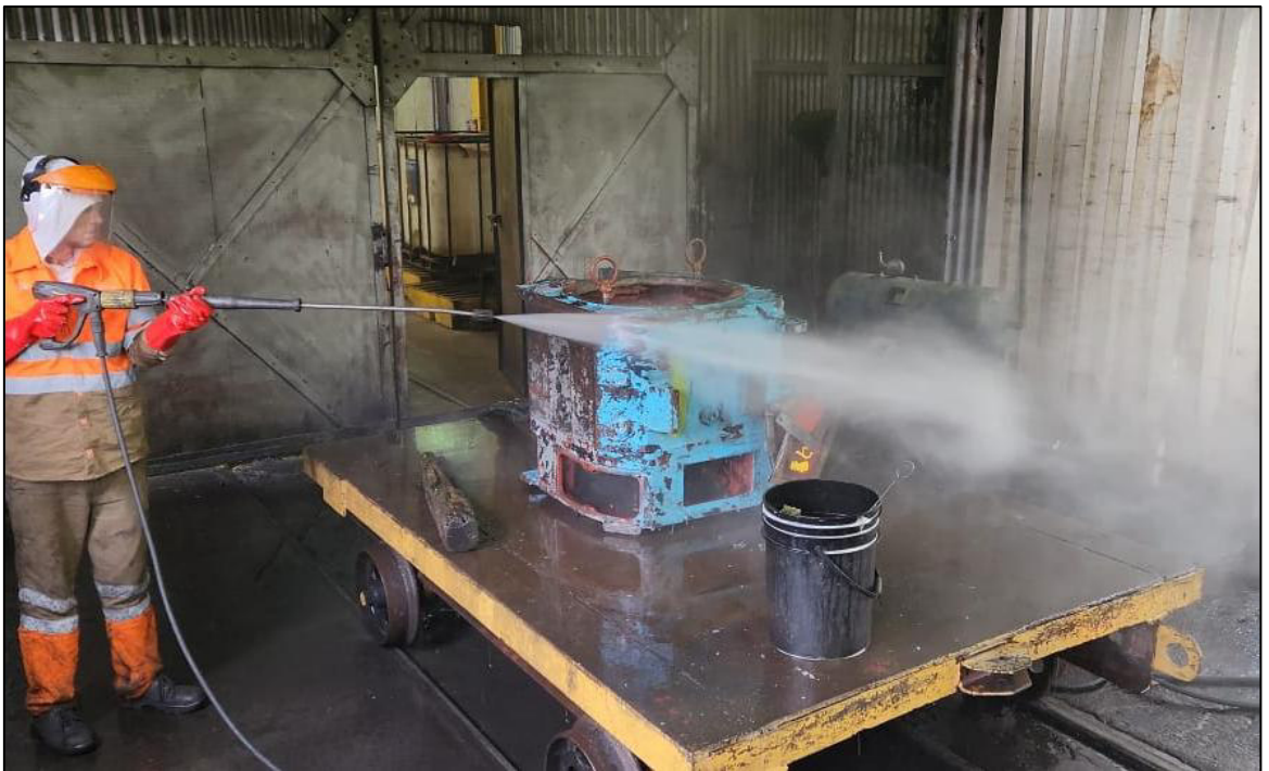
Figura 23- Lavado de estator de motor
