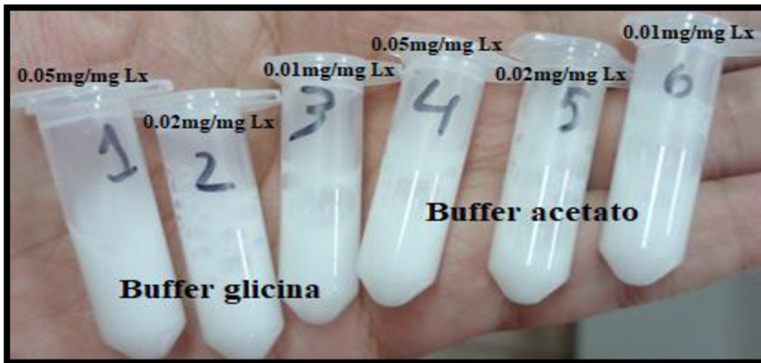
Figura 35: Reactivos de látex producidos. (1, 2, 3 buffer glicina; 4, 5, 6 buffer acetato) (Lx: latex). En la parte superior de la imagen se indican los valores J de cada reactivo (valor J: mg de histoplasmina / mg de látex)
