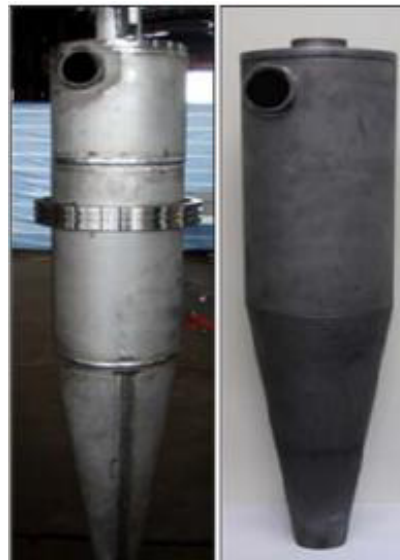
Figura 15 – Internos intercambiables. Izquierda: material dúplex. Derecha: material carburo de silicio
