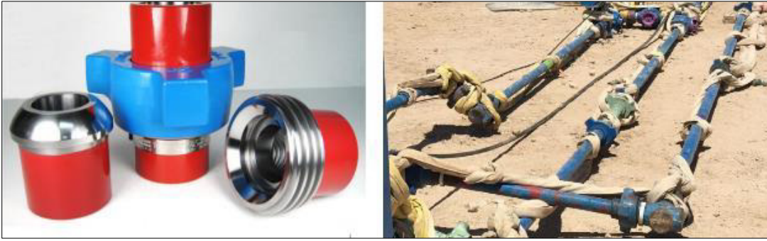
Figura 26 – Uniones WECO y eslingas de seguridad
