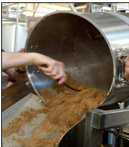
Figura 4. Extracción de bagazo del macerador. Fuente: Min. de Agric. Gan. y Pesca, 2021.
