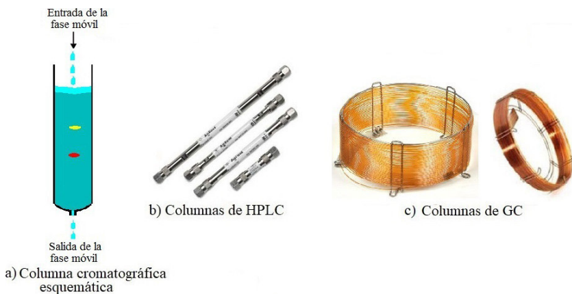
Figura N.º 3. Columnas de cromatografía.
