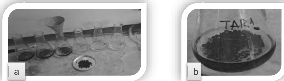
Figura 6: a- Agregados antes y b- Después de la desagregación mecánica.
