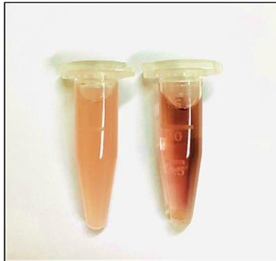
Imagen 8. Suspensión de los sistemas conteniendo nanopartículas de oro soportadas sobre proteínas de capa-S. Izquierda: sistema Au/SLP-NaBH 4 (obtenido empleando el extracto completo); derecha: sistema Au/SLP sb -NaBH 4 (obtenido empleando el extracto centrifugado).
