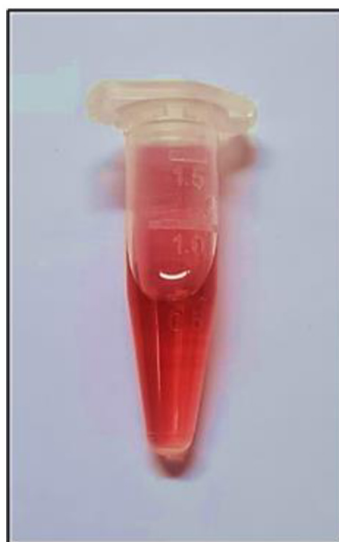
Imagen 9. Suspensión del sistema AuNPs col , nanopartículas de oro coloidal sin estabilización.
