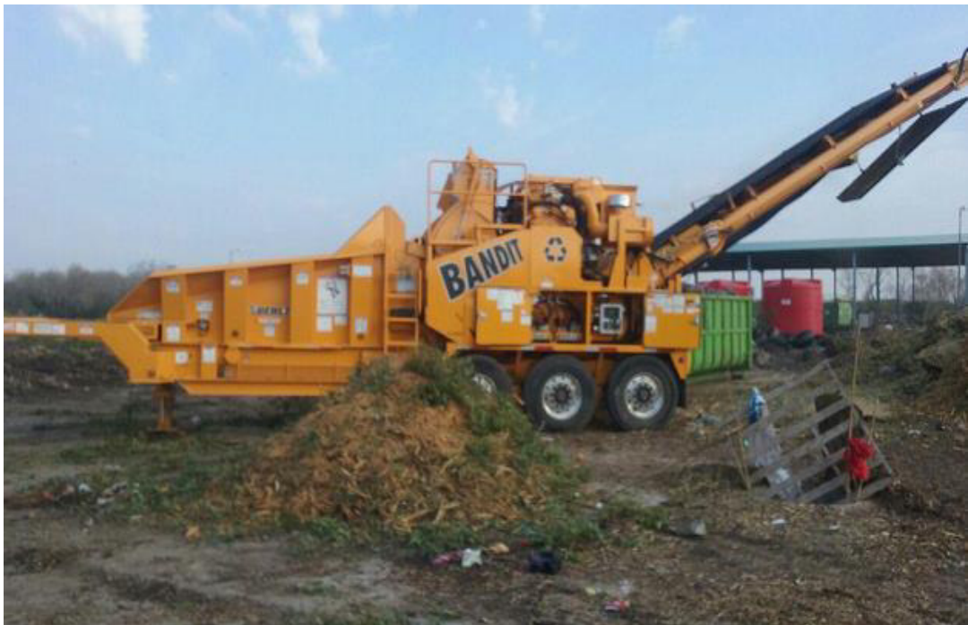
Figuras 12 Chipeadora Bandit para triturar poda.
