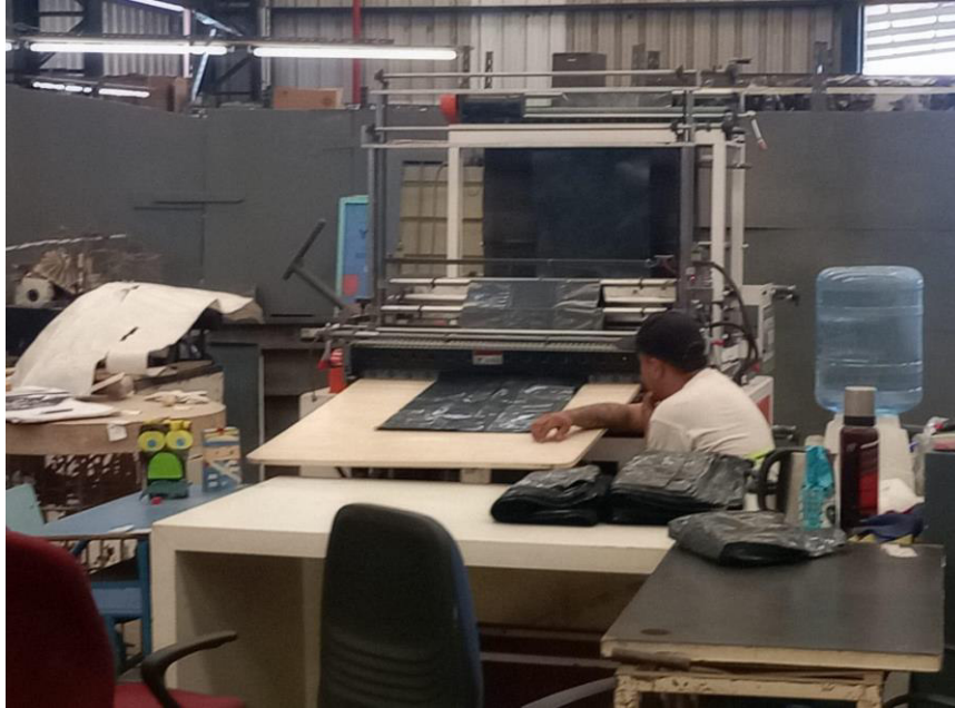
Figura 15 Máquina selladora de bolsas.
