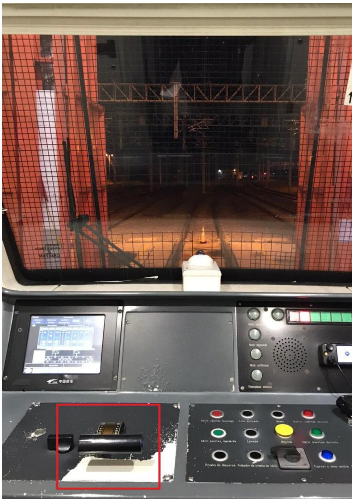
Fig. A15 – Controller visto desde el asiento del conductor
