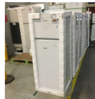
Figura 9: Heladera con piezas de EPS colocadas (Fuente propia)
