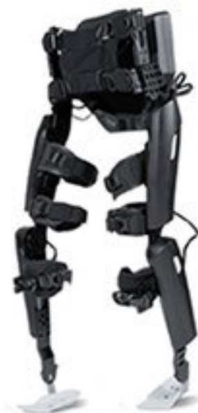
Figura 1. Modelo de Exoesqueleto Robótico con motores bilaterales en cadera y rodilla, y asistido por resortes en tobillo.
