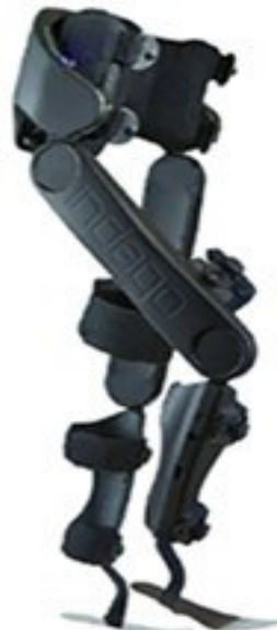
Figura 2. Diseño de Exoesqueleto Robótico con 5 componentes modulares y 4 motores.
