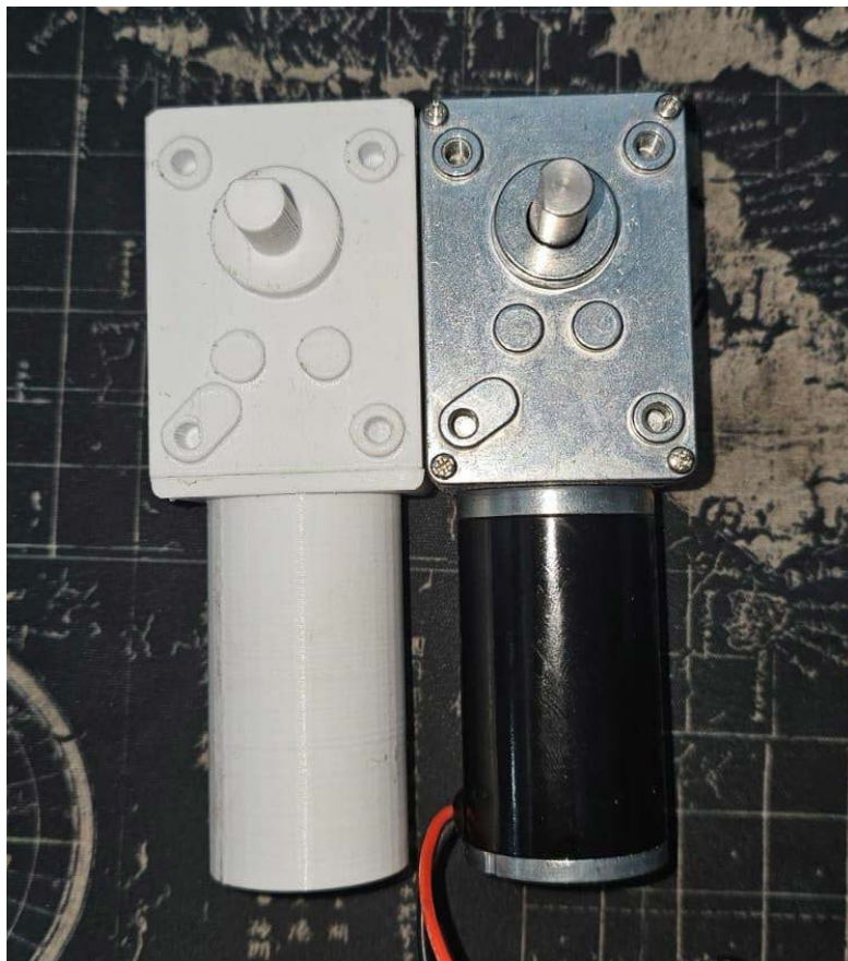
Figura 4.6.1 - Prototipo impreso en 3D del motorreductor junto al componente original. Fuente: Propia
