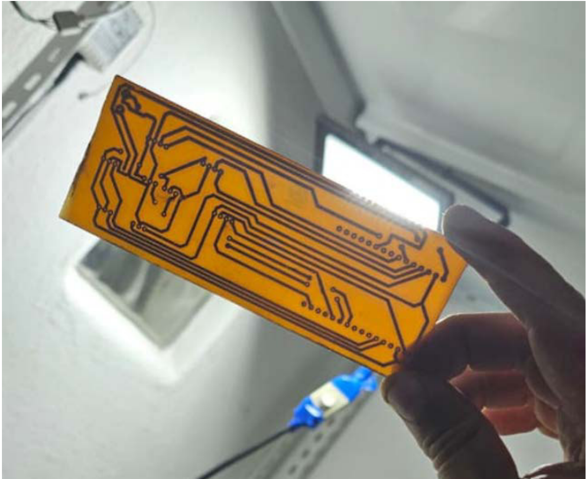
Figura 3.3.5b: Circuito ya impreso en placa Fuente: Propia
