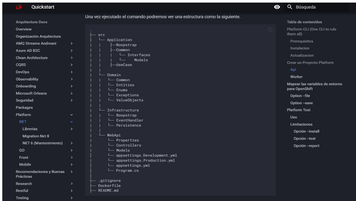
Figura 2.2: Estructura de directorios del template corporativo de Andreani basado en Clean Architecture. Fuente: Documentación oficial de Arquitectura de Andreani
